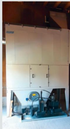
Dauer zu teuer. Die Anschaffung eines neuen Entstaubers mit untergebauter Brikettierpresse war in diesem Fall die perfekte Lösung. Die wichtigsten Kriterien der neuen Anlage waren:
