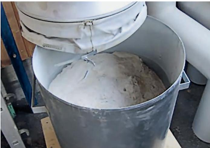
Der Abscheidegrad des Zyklons ist hoch und das Mehl unter Umständen deponierbar.
